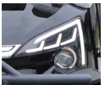
LED SCHEINWERFER mit Lupenprojektion für höhere Leuchtdichte
