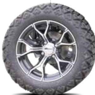
RÄDER Großer Durchmesser 23 Zoll auf 14 Zoll Aluminiumfelge 150 mm Bodenfreiheit
