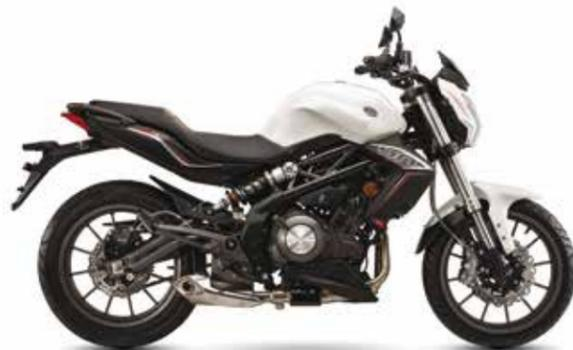
MOTORTYP: 2-Zylinder Reihenmotor DOHC, flüssigkeitsgekühlt
