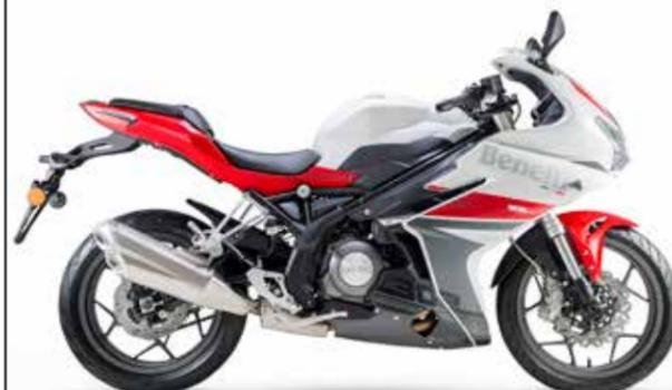
MOTORTYP: 2-Zylinder Reihenmotor DOHC, flüssigkeitsgekühlt
